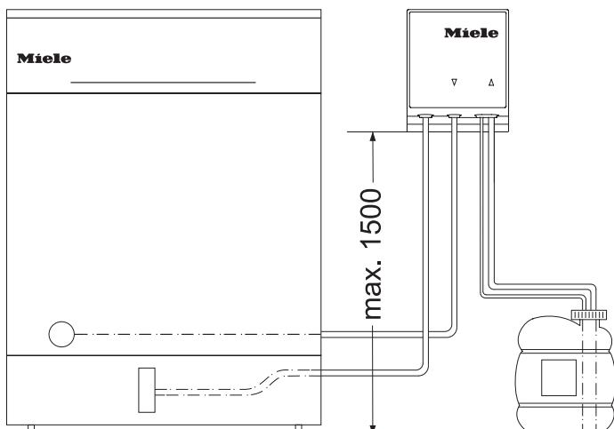
Altura máxima del desagüe. 1,5 m
